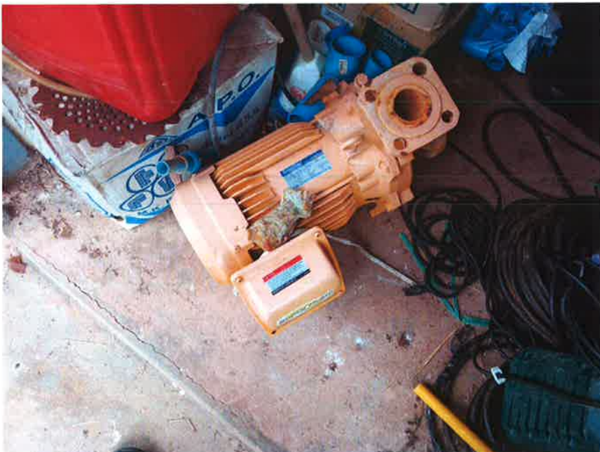
๓. เครื่องสูบน้ำบาดาล ๑ เฟส ๑ แรงม้า
